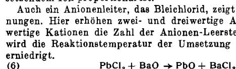
Auch ein Anionenleiter, das Bleichlorid, zeigt analoge Erscheinungen. Hier erhöhen zwei- und dreiwertige Anionen oder einwertige Kationen die Zahl der Anionen-Leerstellen. Gleichzeitig wird die Reaktionstemperatur der Umsetzung (6) entsprechend erniedrigt.
